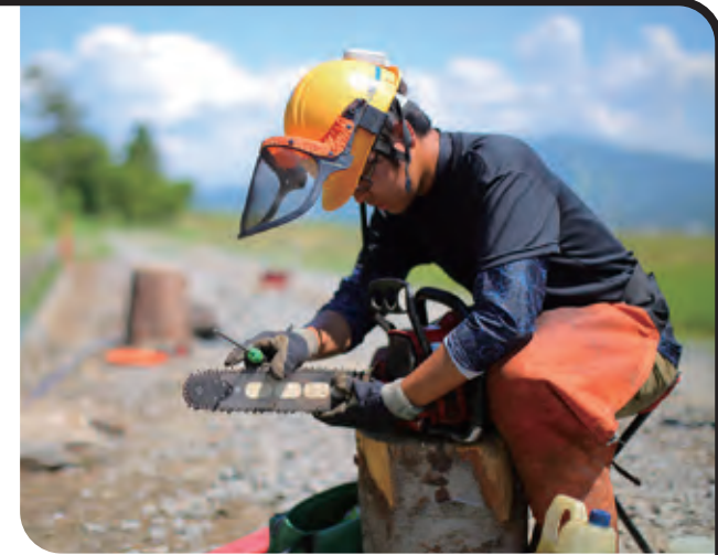
会社から支給されるチェーンソー。安全のためにしっかり目立て(整備)します。
